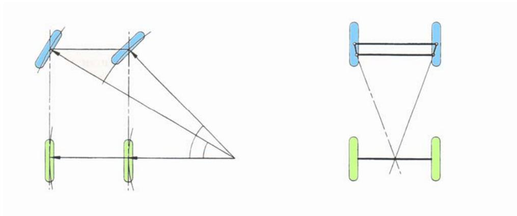
Pour que les roues se mettent en bonne position, en virage, Jeantaud s'est aperçu qu'il fallait, en ligne droite, que les prolongements des deux leviers de fusée se rejoignent au milieu de l'essieu arrière.
