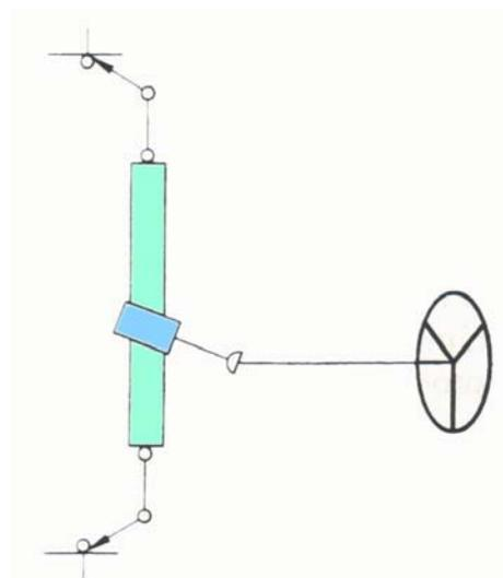
Le volant fait tourner un pignon par l'intermédiaire du tube de direction qui doit être articulé.
