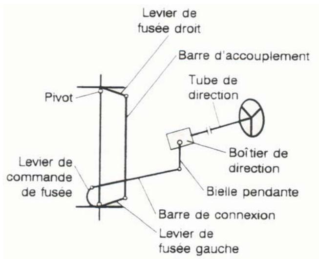
En tournant le volant à droite ou à gauche, le conducteur fait pivoter la bielle pendante en arrière ou en avant grâce au renvoi d'angle contenu dans le boîtier de direction.
