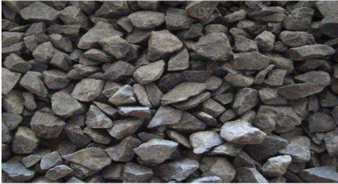
**Granulat artificiel** : c'est un granulat résultant des procédés industriels comprenant des modifications thermiques.
