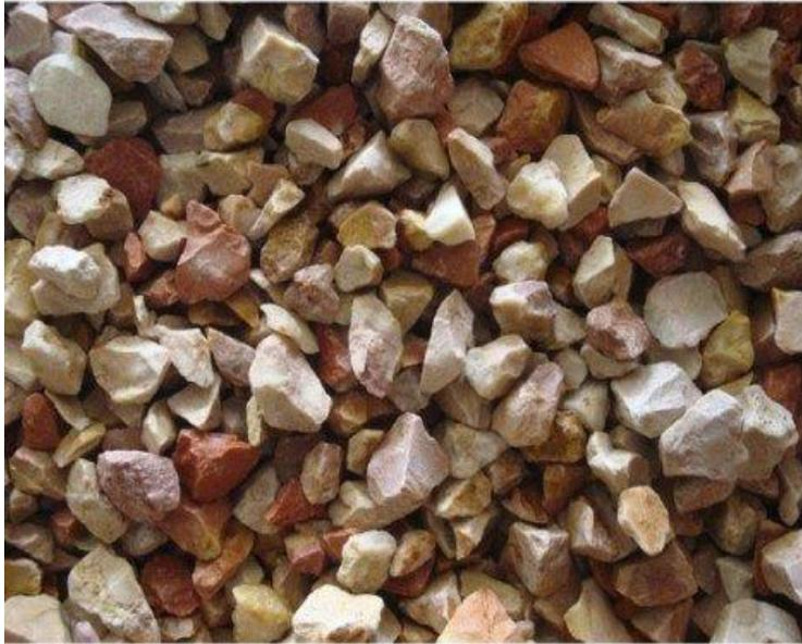
**Un granulat recyclé** : c'est un granulat résultant de la transformation de matériaux inorganique antérieurement utilisés dans la construction
