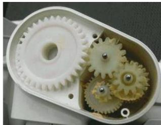
Fig. 10 : Exemple de réducteur de vitesse à d'engrenages
