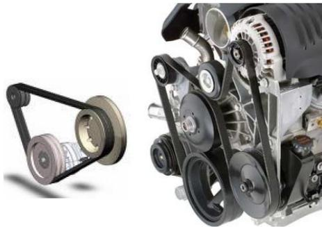
Fig. 5 : Exemple de système poulie-courroie pour un moteur thermique
