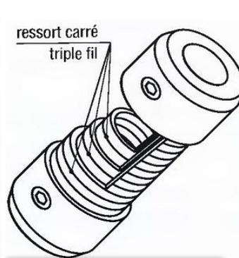
Fig.11 : ressort carré triple fil élastique en torsion et en flexion
