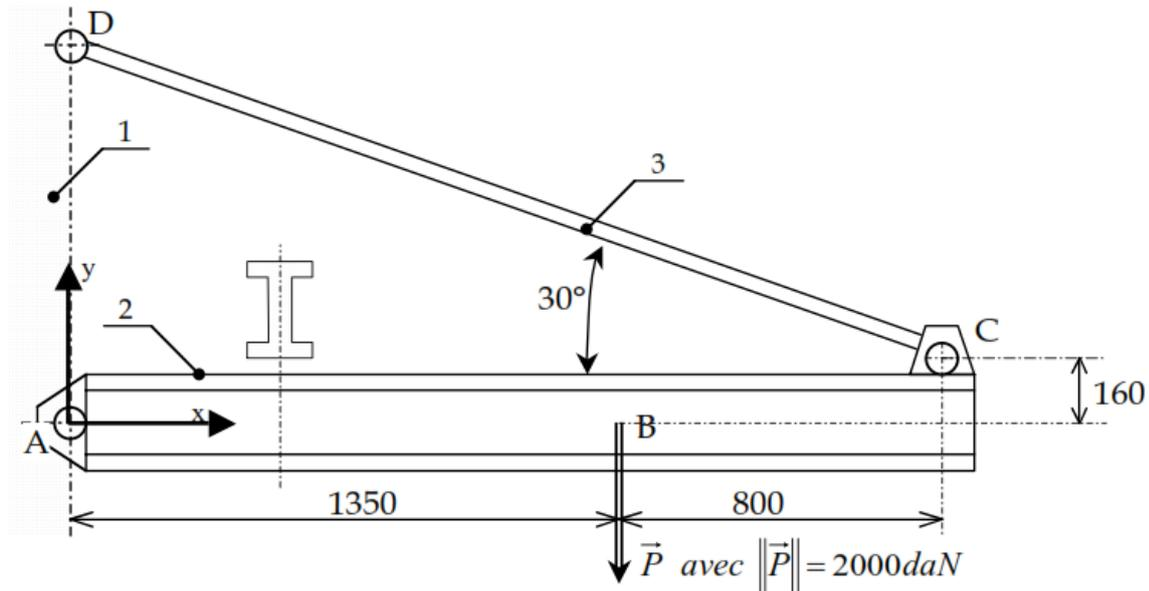
Figure 3 : Exemple d'une potence à tirant
