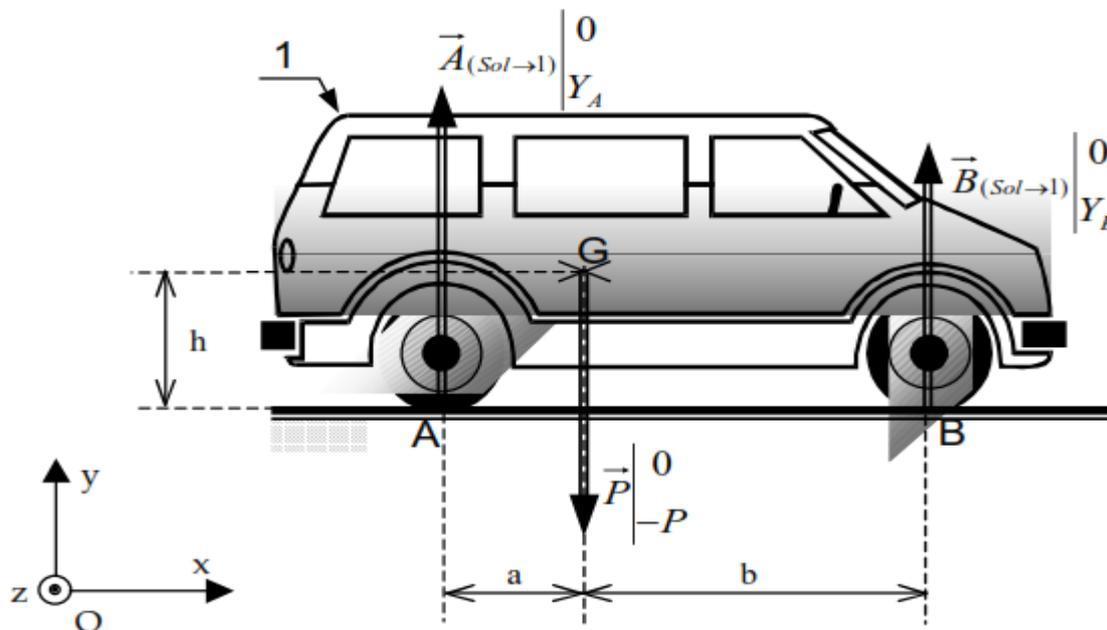
Figure 4 : Equilibre d'un véhicule sur un sol horizontal.
