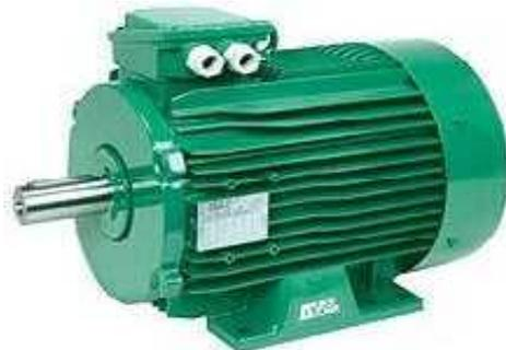
Le moteur asynchrone est une machine tournante à courant alternatif qui, recevant de l'énergie électrique, fournit une énergie mécanique. Son rotor tourne à une vitesse inférieure à celle du champ statorique. Il est constitué de deux parties essentielles: une partie fixe (**le stator**) et une partie mobile (**le rotor**).
