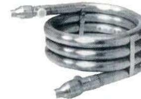
Ils sont constitués par deux tubes enfilés l'un dans l'autre. Le fluide frigorigène circule entre les deux tubes. Avec ce type de condenseur il faut utiliser un réservoir de liquide.
