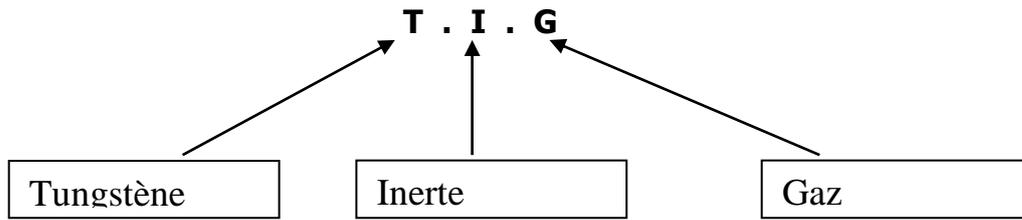
Procédé de soudage : l'arc électrique est établi entre la tôle à souder et une électrode non fusible en W protégé par un gaz inerte. ( Argon ou hélium )
